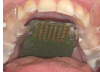
Figure 5, Photo du TDU télémetrique (matrice de 6 × 6 électrodes)
