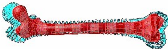
Figure 9.6 - Maillage d'un fémur entier patient (le plus petit des deux fémurs), après mise en correspondance, superposé au nuage de points du fémur de référence.
