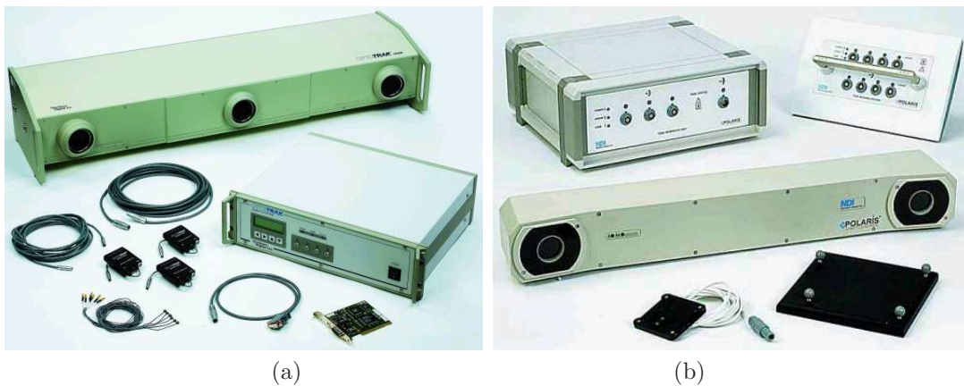
FIG. 1.8 – Exemples de localisateurs optiques : (a) Optotrak et (b) Polaris
