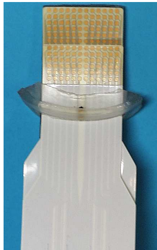
FIG. 4.3 – L'image montre la matrice d'électrodes du TDU avec le support prototype de fixation construit en plexiglas. Le protecteur dental a été adapté pour fixer le support.
