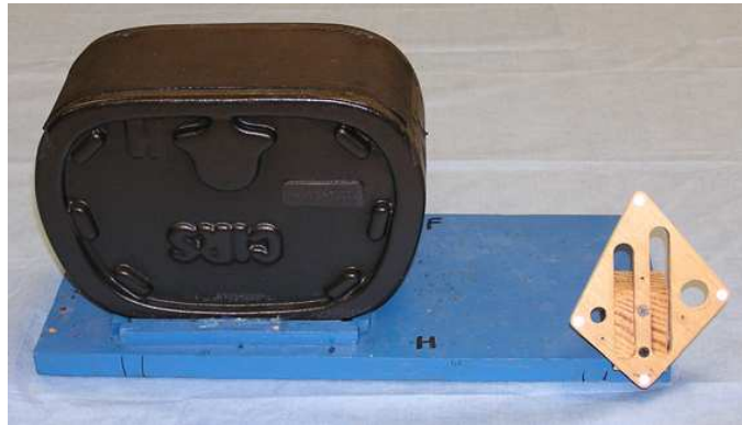
Fig. 26. Photographie du modèle abdominal utilisé dans l'expérience. L'intérieur de ce modèle ("Phantom") contient une représentation en volume et en densité réaliste de certains organes de la cavité abdominale.
