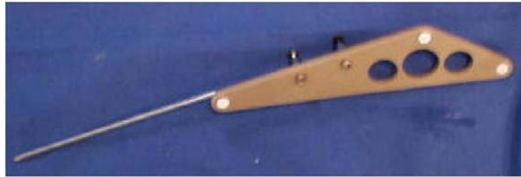
Figure 15 : Aiguilles avec pastilles réfléchissantes placées sur un corps rigide.
