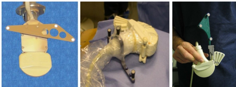
Figure 49 : De gauche à droite – développement chronologique des différents corps rigides fixés sur la sonde d'échographie.
