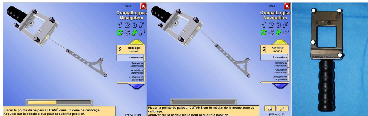
Figure 41 : à gauche et au milieu : interface de navigation guidant le calibrage du palpeur cutané dans les deux emplacements prévus à cet effet, le premier conique et le second plat. A droite : calibreur de l'ancillaire chirurgical de navigation.
