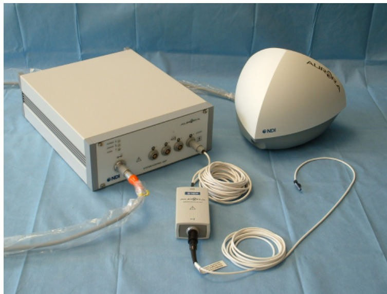
FIG. A.1 – Le localisateur magnétique Aurora ® : générateur de champ, capteur, tous deux reliés au boîtier de contrôle qui envoie les informations à l'ordinateur.
