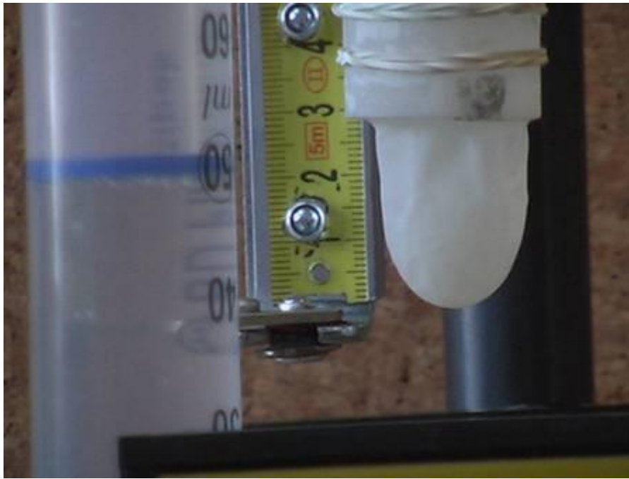
Figure 22 : Gros plan sur la membrane convexe soumise à une hauteur d'eau de 2cm
