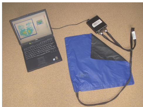
(a) Nappe de pression et logiciel Vista Medical montrant un exemple de cartographie de pression
