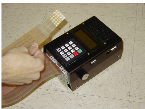
(a) Boitier électronique contrôlant les électrodes
