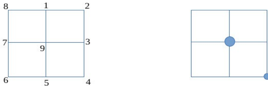
Figure 2.11. Système de codage des chiffres conçu par Saunderson. À gauche, les différentes position que peuvent prendre les épingles pour désigner un chiffre. À droite, un exemple de code avec le numéro 4.
