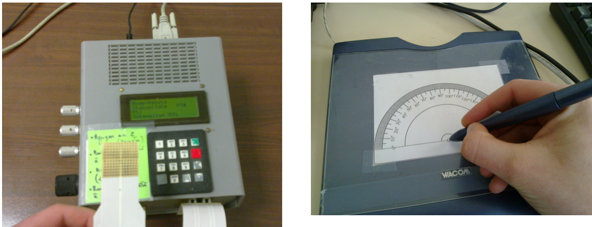
Figure 3.3. (Gauche) Tongue Display Unit, Unité d'affichage sur la langue composé d'un boîtier électronique et une matrice d'électrostimulation comprenant 144 électrodes (12x12). (Droite) Tablette graphique et stylet pour tracer les réponses (lignes orientées). On distingue un abaque d'angles pouvant servir de référence pour les sujets.
