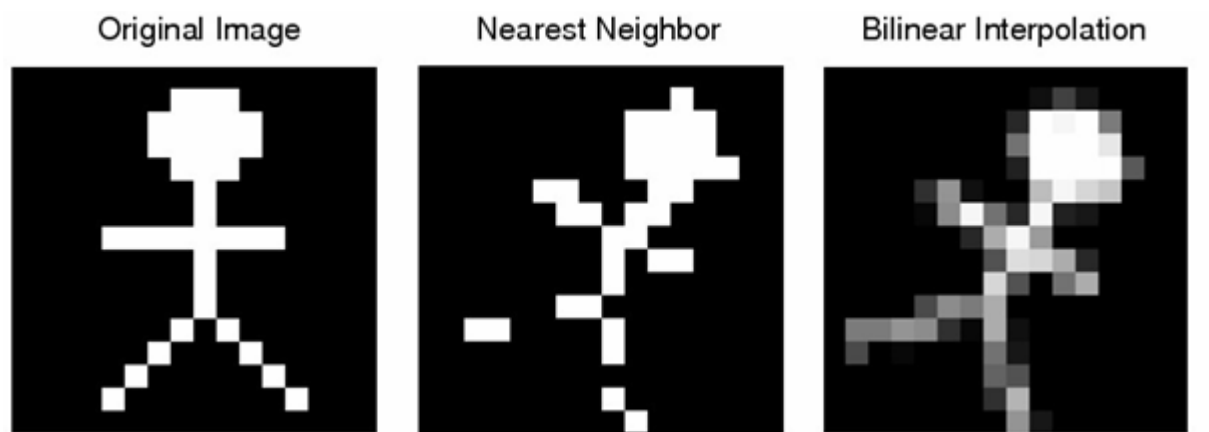
FIGURE 4.1 – Influence de deux types d'interpolations couramment utilisés en vision sur une image bidimensionnelle simple inclinée. (Gauche) Modèle original. (Centre) Reconstruction de l'image en utilisant un algorithme « Nearest-Neighbor » qui assigne la valeur de couleur du pixel courant à celle du plus proche voisin. (Droite) Reconstruction de l'image en utilisant un algorithme d'interpolation bilinéaire qui, pour chaque pixel créé une moyenne pondérée des quatre pixels les plus proches.
