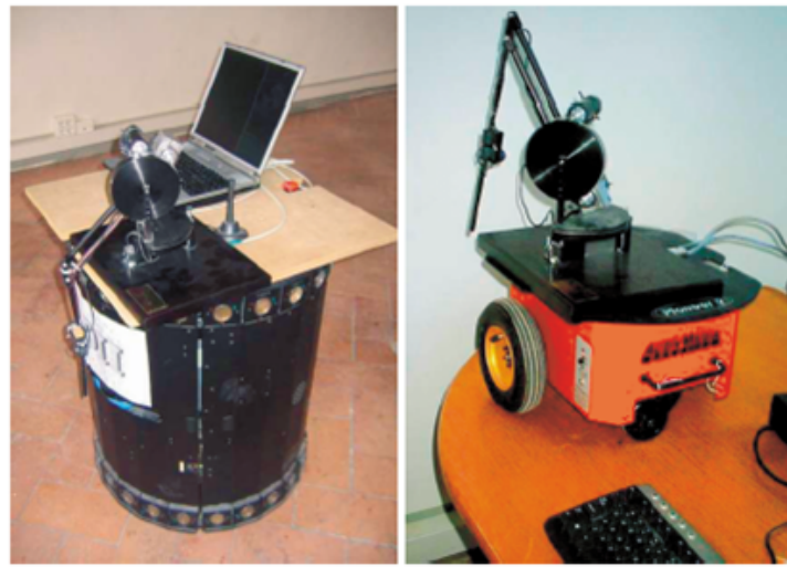
FIGURE 2.13 – Exemple de robots porteurs. Un dispositif manipulable (PHANTOM Premium 1.5) est posé sur le transporteur d'après Barbagli (2006).
