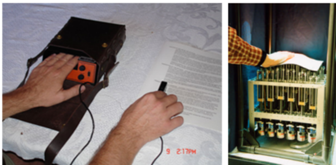
FIGURE 2.8 – a) (Haut). Matrice d'aiguilles métalliques [Shimojo1997]. b) (Bas gauche). OPTACON : Dispositifs de lecture et conversion en braille [Goldish1974]. c) (Bas droite). FEELEX : Simulation d'une surface par déformation [Iwata2001].
