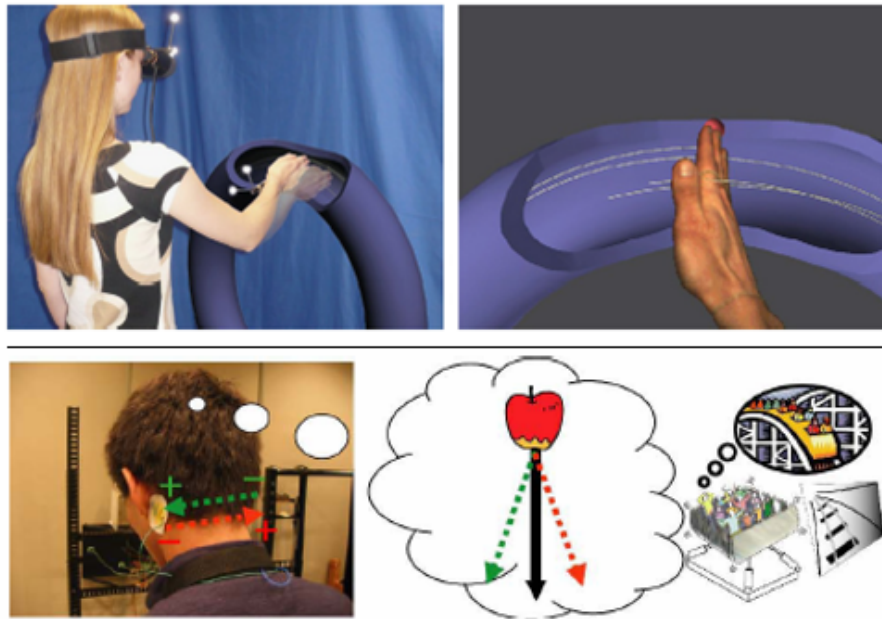
FIGURE 2.19 – a) (Haut). HEMP (hand-displacement-based pseudo-haptics) (Pusch 2009). b) (Bas) . Dispositifs galvanique de stimulation vestibulaire, permettant la simulation d'une accélération (Maeda 2005).
