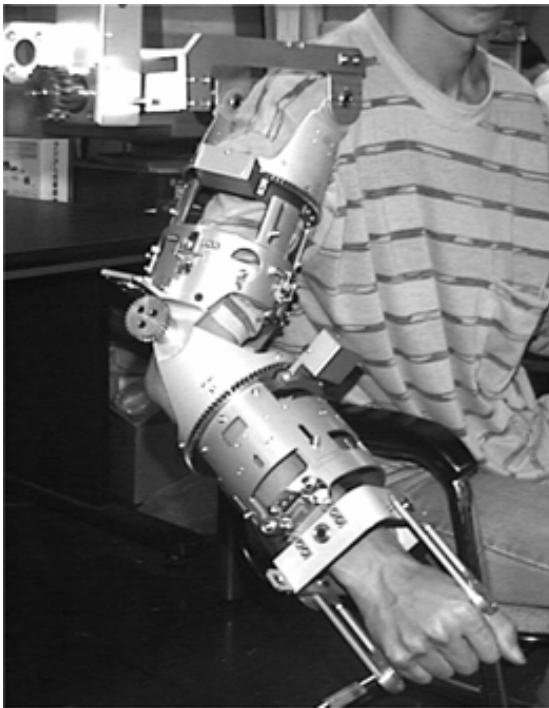
FIGURE 2.12 – a) (Gauche). Exosquelette à 7 degrés de liberté Sensor Arm. D’après Nakai (1998). b) (Droite). CyberGrasp : exosquelette à base portable permettant de simuler la préhension. CyberGlove (2009).
