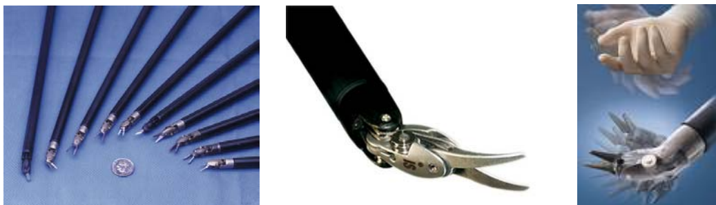
figure 21 : les instruments du système Da Vinci et leurs nombreux degrés de liberté grâce au système EndoWrist.
