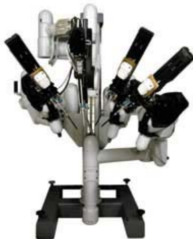
figure 19 : bras robotisés du système Da Vinci.
