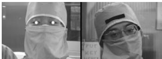
figure 33 : détection des pupilles du chirurgien ou d'une bande noire collée sur sa calotte pour commander un robot porte-endoscope par des mouvements de tête [59].
