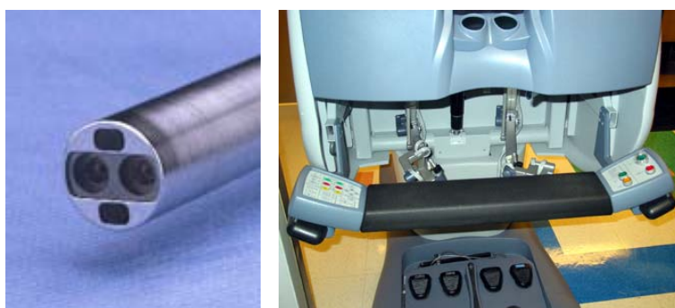
figure 23 : l'endoscope stéréoscopique du Da Vinci (à gauche) et les pédales qui permettent de le piloter sur la console.
