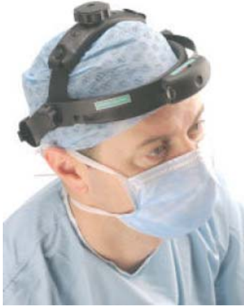
figure 15 : casque infrarouge du système EndoAssist permettant au chirurgien de commander les déplacements de l'endoscope.
