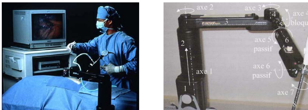
figure 12 : le bras du système AESOP fixé sur la table d'opération et ses degrés de liberté (l'image de droite a été obtenue dans [32]).
